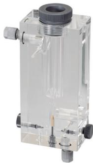
La sonde chlore libre doit être utilisée avec sa cellule de passage spécifique
