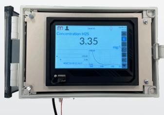
Les mesures démarrent dès la mise sous tension du msBox.
