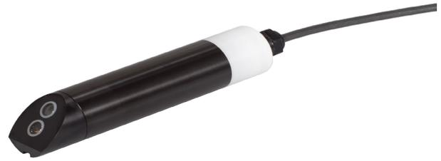
La sonde TTurb est un capteur numérique pour la mesure optique de la turbidité utilisant la méthode de la lumière infrarouge diffusée à 90°. Selon la version du capteur, il peut être utilisé en eau potable jusqu'à 100 FNU ainsi que dans de l'eau brute, en eaux usées et eaux de process jusqu'à 1000 FNU. La sonde TTurb est disponible avec différentes longueurs de câbles (10 m ou 2 m).
