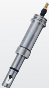
L'hydrogène dissous passe à travers la membrane perméable aux gaz. Il se diffuse jusqu'à l'électrode de travail où s'opère une réaction d'oxydation électrochimique. Le courant généré, proportionnel à la pression partielle d'hydrogène dissous est mesuré par la sonde.
