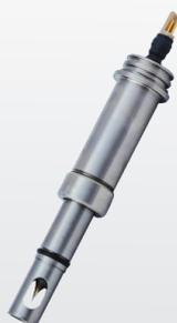
L'H<sub>2</sub>S dissous passe à travers la membrane perméable au gaz. Il se diffuse jusqu'à l'électrode de travail où s'opère une réaction d'oxydation électrochimique avec l'électrolyte adaptée à l'H<sub>2</sub>S. Le courant généré, proportionnel à la concentration en H<sub>2</sub>S, est mesuré par la sonde.
