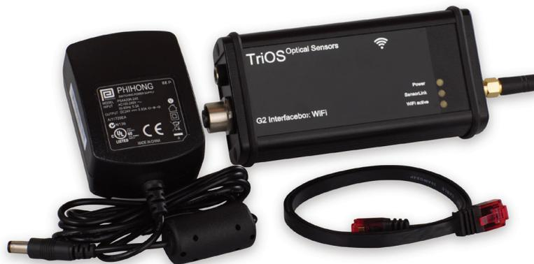
Boîtier interface pour une utilisation rapide et simple des capteurs TriOS numériques G2. Une fois raccordé sur une prise secteur, ce boîtier permet d'alimenter le capteur et d'ouvrir l'accès à son interface web G2. La connexion LAN se fait à l'aide d'un câble Ethernet ou par Wi-Fi, l'interface est accessible depuis n'importe quel navigateur web sur smartphone, tablette et ordinateur.
