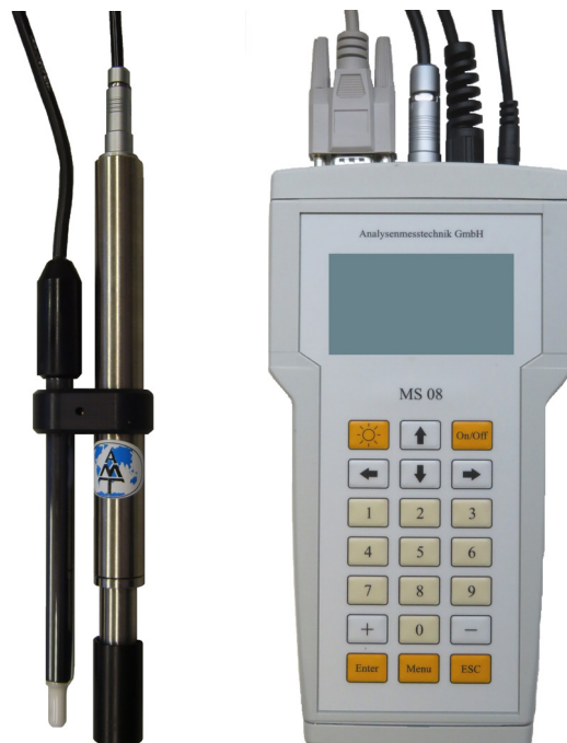
Boîtier MS08 - adapté pour les micro-capteurs H 2 - H 2 S - H 2 O 2 - O 2 et O 3
